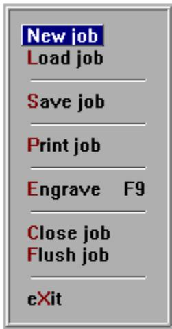
Esta característica crea un trabajo vacío en la pantalla principal de VISION usando los parámetros definidos en la instalación de VISION. Estos parámetros se pueden cambiar usando el menú Sistemas Preferencias en VISION.
